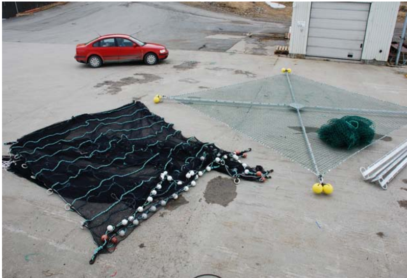
Figur 4. Rammeverk med stramt bunnpanel (= trampolinebunn). Lagringspose påmontert fløyt, ringer for opphalingsvinsjer samt megafløyt (flytetau) for samling og flotasjon av løst nett når merden skal heises opp og brislingen skal trenes.
