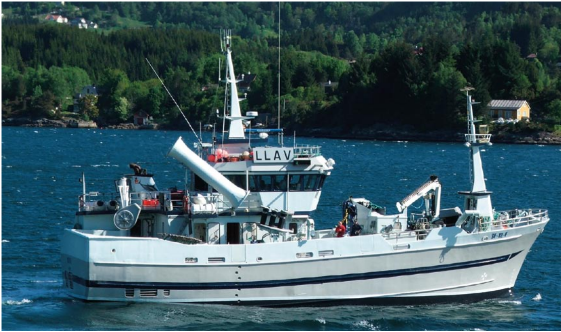
Bluefin er bygget i kompositt-/ sandwichmaterialer av Mundal Båt AS. Bildet visert fartøyet etter en forlengelse fra 70 til 90 fot.
