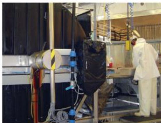
I systemet til Are AS bedøves fisken i vann inne i en isolert plastylinder.
