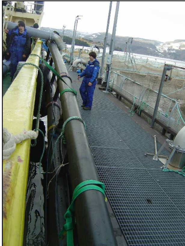
Bilde 3 Mammutpumpe var montert langs rekken på B/B Tauranga når den ikke var i bruk.
