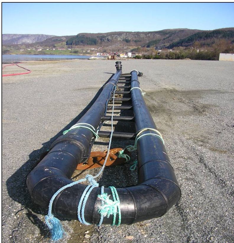
Bilde 16 Norges største mammutpumpe?
