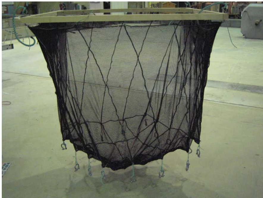
Figur 9. Modellforsøk av nytt konsept med skrå sidetau og skrått notlin.
