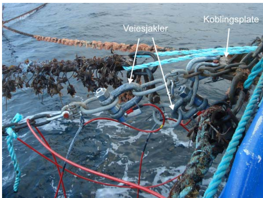
Fig. 4. Montering av veiesjaklene mellom kjettinger og koblingsplater.
