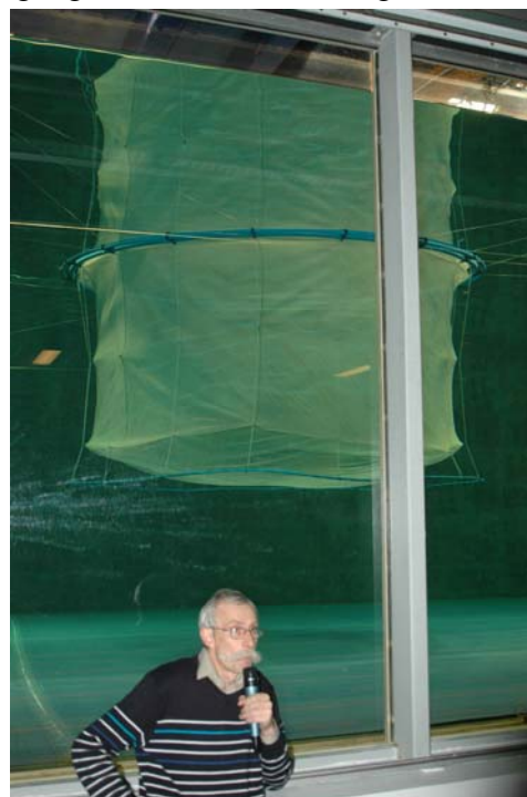
Bilde 6. Kurt Hansen fra SINTEF i Hirtshals demonstrerte hvordan en not med ulike typer loddsetting kan påvirkes av strømkrefter.
