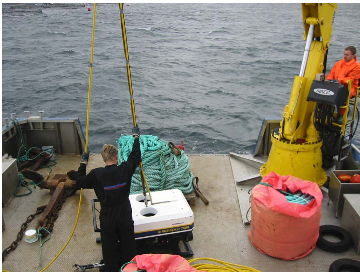
Figur 2. Utsetting av ROV.
