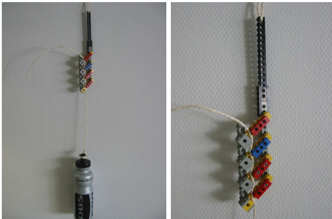
Figur 16. Modell i LEGO hengt opp på vegg, og belastet med en vannflaske.
