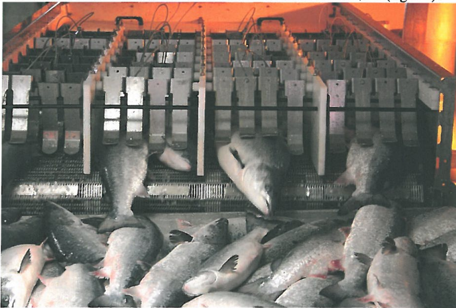
Figur 1. Tilfeldig orientering av laks gjennom elektrobedøvingsenhet.
