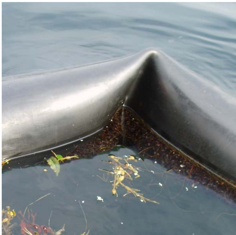
Figur 5 Eksempel på lokalt kollaps av tverrsnitt.
