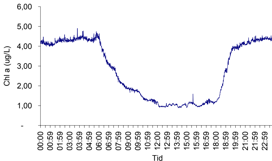
Figur 6. Figuren viser et eksempel på døgnvariasjonen i Chl a mengde i vanninntaket hos Sævareid Fiskeanlegg AS (beregnet fra fluorescensmålingene). Serien er fra 5. juni 2007.
