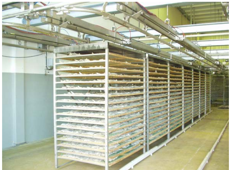
Figur 1. Bilde av hengende reoler ved langblåst tørke fra Optimar. Disse reolene inneholder ferdig klippfisk, og de er kjørt ut av tunnelen og står på vent for tømning av brettene, som foregår automatisk.
