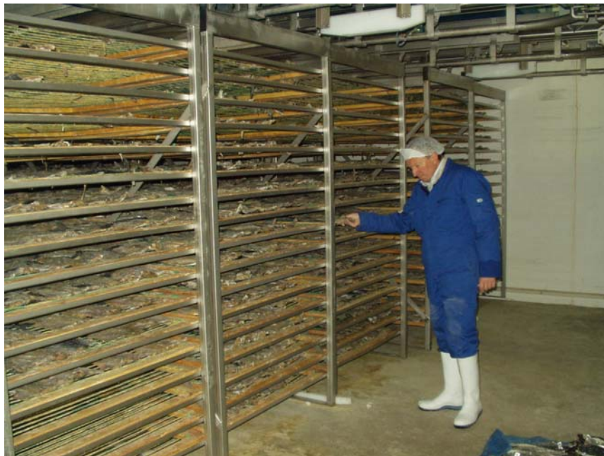
Figur 1. Bilde av hengende reoler i den langblåst tørken fra Optimar. Bildet er tatt i våt ende av tunnelen, der hvor våt fisk lastes inn.
