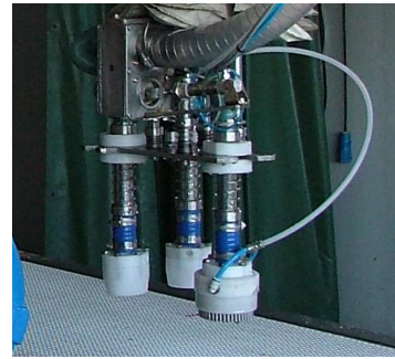
Griper med patentert griperhode
