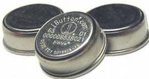
Figur 4. Temperaturloggere type: DS1922L-F5# - Thermochron iButton fra produsenten Maxim.
