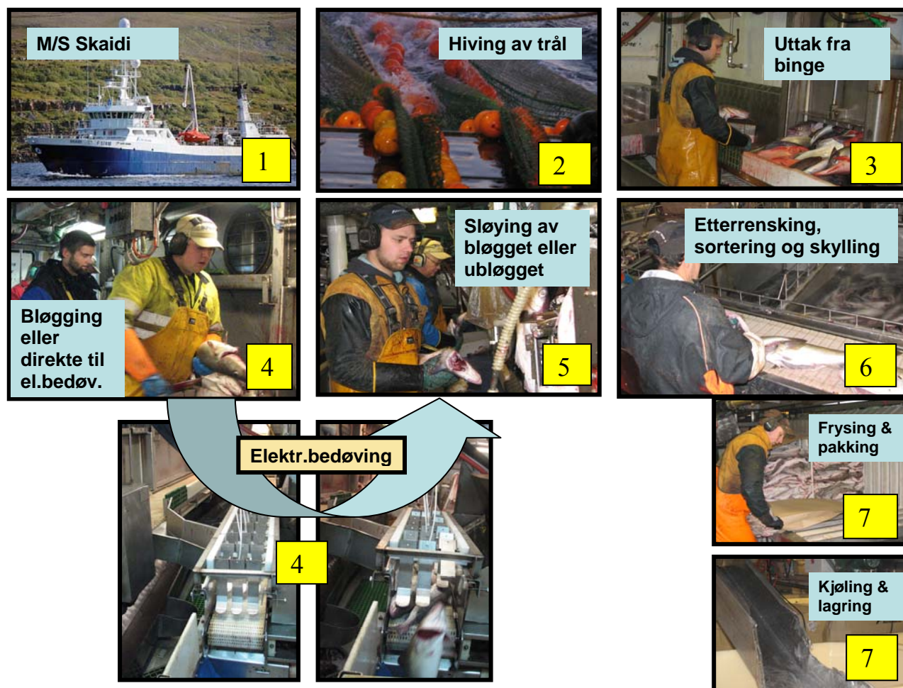
Figur 1. Fangstbehandling om bord i tråleren (steg 1 til 7). Etter at trålen blir halt opp på dekk blir fisken sluppet ned i to mottaksbinge (uten vann). Der blir den mellomlagret til den blir bløgget og sendt til tørrutblødning (uten vann) før maskinell sløyning og hodekapping, manuell etterrensning, sortering og skylning. Alternativt går fisken direkte til sløyemaskin (uten bløgging). Elektrobedøver ble plassert ved mottaksbinge før bløgging som et alternativt trinn i prosesseringen.
