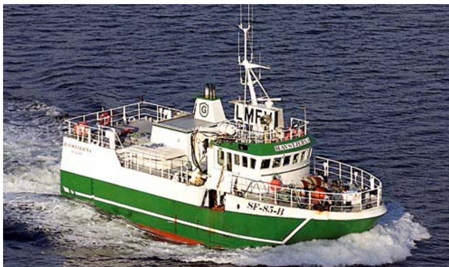
Figur 1. Det kombinerte line- og garnfartøyet M/S "Havstjerna". Lengde 21,0 m, bredde 6,4 m og dybde 5,4 m.
