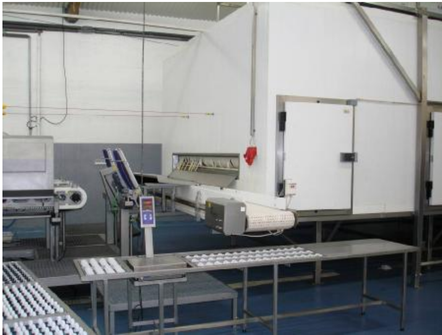
Figur 10. Skinnkjølerens utmatingsende. Båndene for overføring av filetene til de to skjære- og skinnelinjene er vippet opp i nesten vertikal stilling. Filetskanneren vises helt til venstre i bildet.
