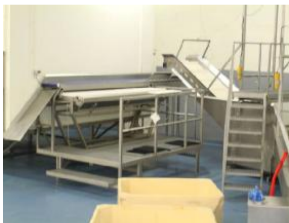
Figur 9. Transportbånd mellom filet- og skinnkjøler. Legg merke til den lille bordplaten på innmatingsplattformen som kan brukes til grovtrimming av enkelte fileter.
