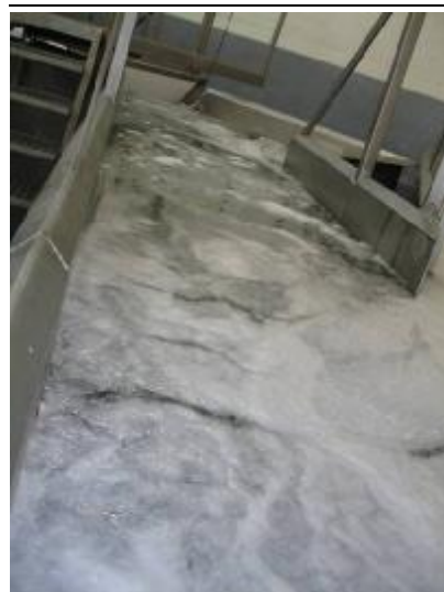
Figur 7. Full filetkjøler sett mot utmatingsenden.
