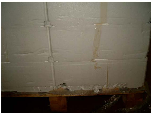
Figur 5. Liten transportskade på nederste lag av EPS-kasser
