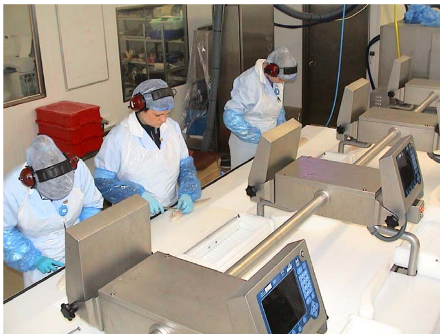
Fig. 6.4 Stasjon for ettertrimming, plassert etter SensorX. Filèter med restbein fordeles automatisk til ledig operatør som trekker ut restbein med tang og foretar kontroll på at filèten er helt beinfri. Operatørene bruker aktivt informasjonen på displayet om hvor restbein befinner seg i filèten. Stasjonen har forbedringspotensiale for ytterligere effektivisering og bedre ergonomi.
