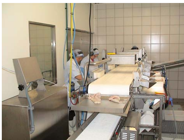
Fig. 6.2 Bildet viser 2 operatører på fortrimmestasjonen, for handtering av venstrefilèter.
