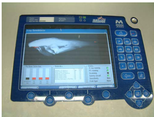
Fig. 6.6 Bilde av panelet på SensorX med visning av analysert røntgenbilde. Nede til venstre på panelet og i tabellen vises statistiske resultater.
