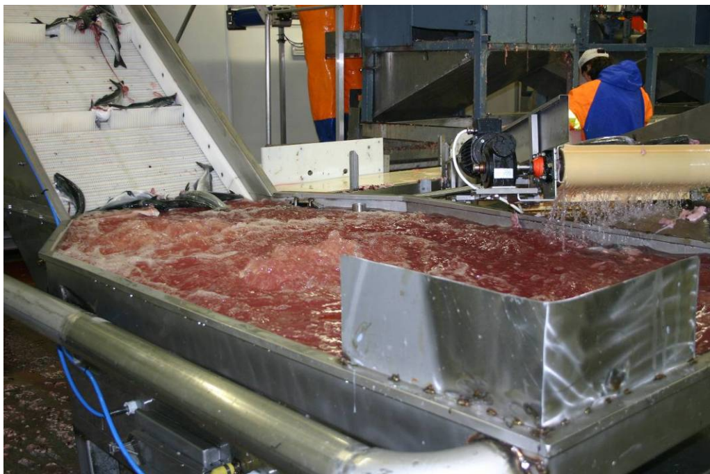
Bilde 14 Bulkløfter med luftbobling for fjerning av lever.
