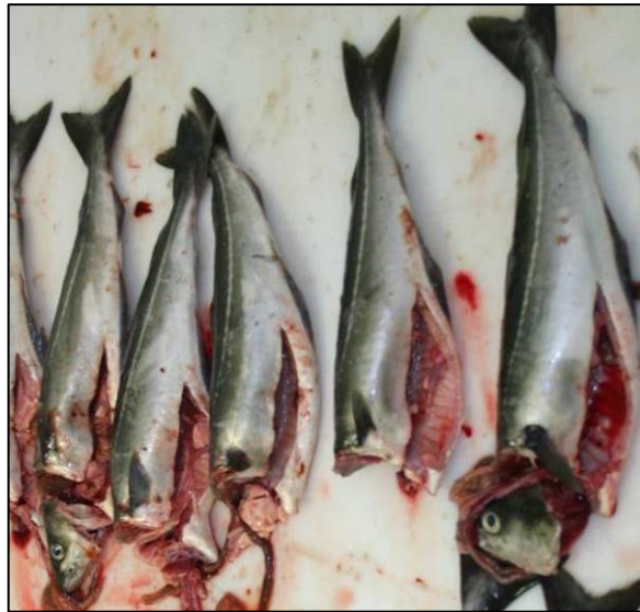
Bilde 12 Rester av slog og lever (venstre) og hode som fortsatt henger på fisken (høyre) etter Baader 166.
