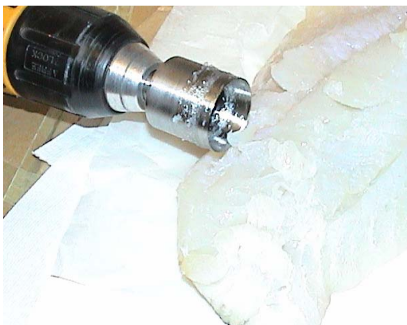
Fig. 5.12 Testing i laboratoriet med roterende sylindrisk kniv. Knivdiameter er 30 mm.
