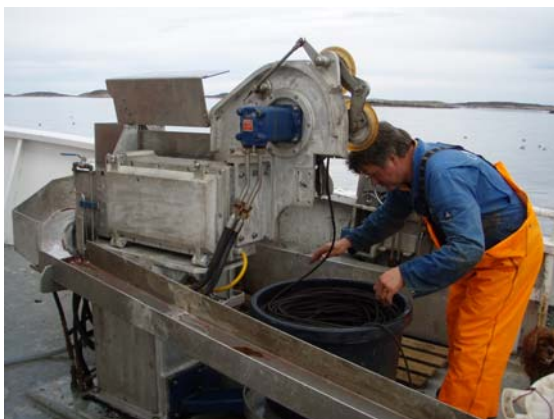
Figur. 9. Sten Holmen ved haleenheten om bord(stampskifte) . Legg merke til fiskeernna som gjør at fisken glir helt av seg selv fra den automatisk avangles av line til den når fiskebingen lengre akterut.
