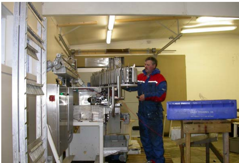
Figur 5. Egnemaskinen på egnestasjonen på Mausund, med Sten Holmen som operatør
