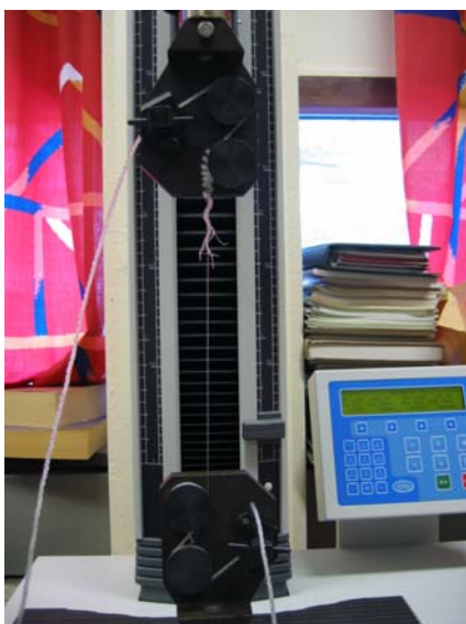
Figur 12. Foto av de ulike linetyperne som det ble foretatt strekktester av
