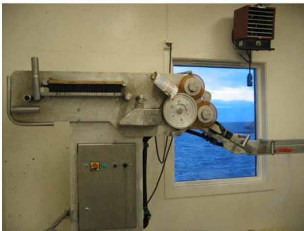
Figur 6. Bøtestasjon for overføring av klargjort line på magasin.
