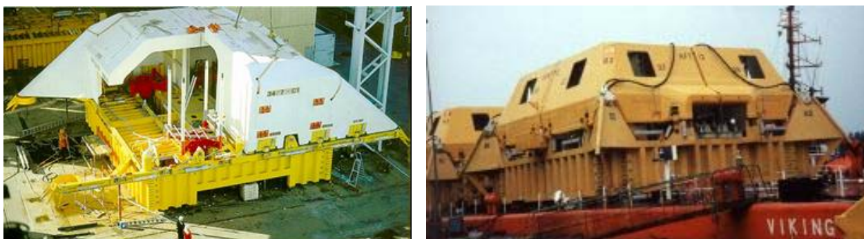
Figur 3.15: Brønnhode beskyttelsesstrukturer i sandwich. Strukturene er levert av ABB Offshore Systems AS som har stått for materialvalg og dimensjonering. Strukturene er produsert av Brødrene Aa as. Dimensjonene på strukturen til venstre fremgår ved å sammenligne med personene på bildet. Dimensjonene på strukturen til høyre er 15 x 15 x 7 m.
