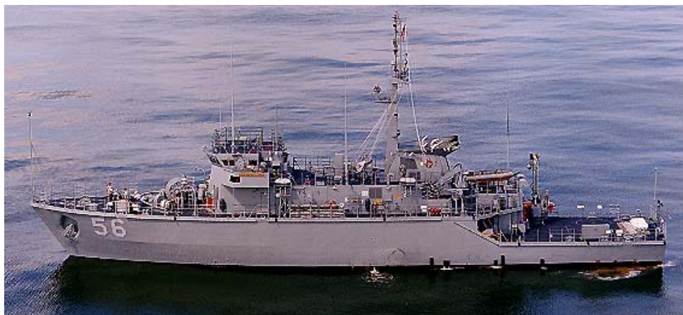
Figur 3.7: Minesveiper i Ospreyklassen bygd i komposittmaterialer (enkeltskall)
