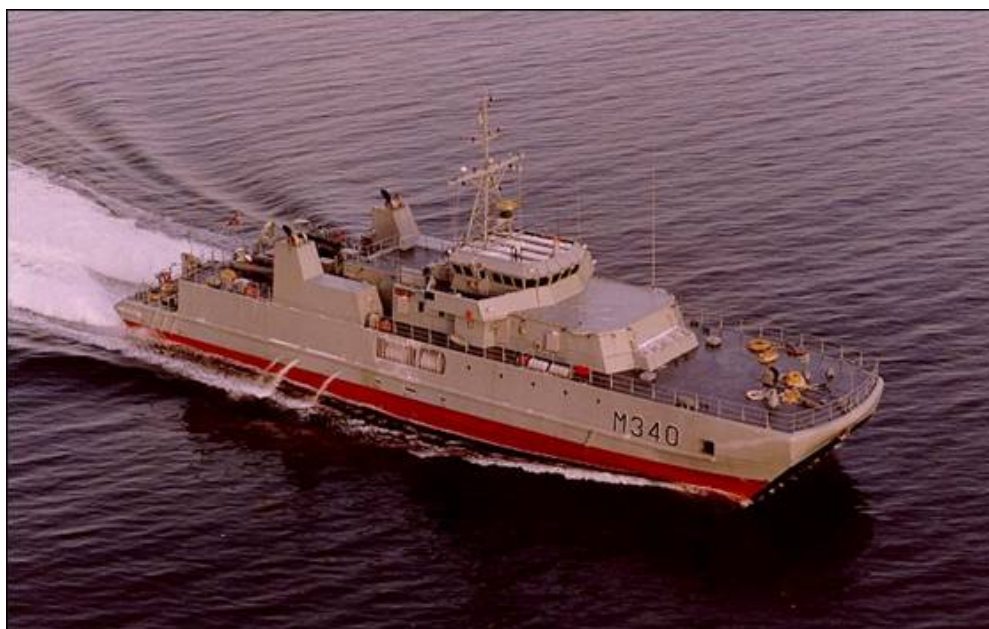
Figur 3.6: Minerydningsfartøy i sandwich (55 m) produsert av Umoe Mandal AS
