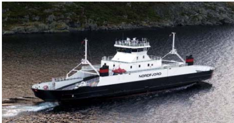
Figur 3.11: Sandwichoverbygg til kystfergen MS Nordfjord
