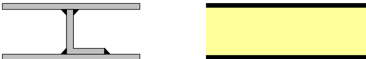
Figur 9: De to tverrsnittene som vurderes. Aluminium og sandwich.
