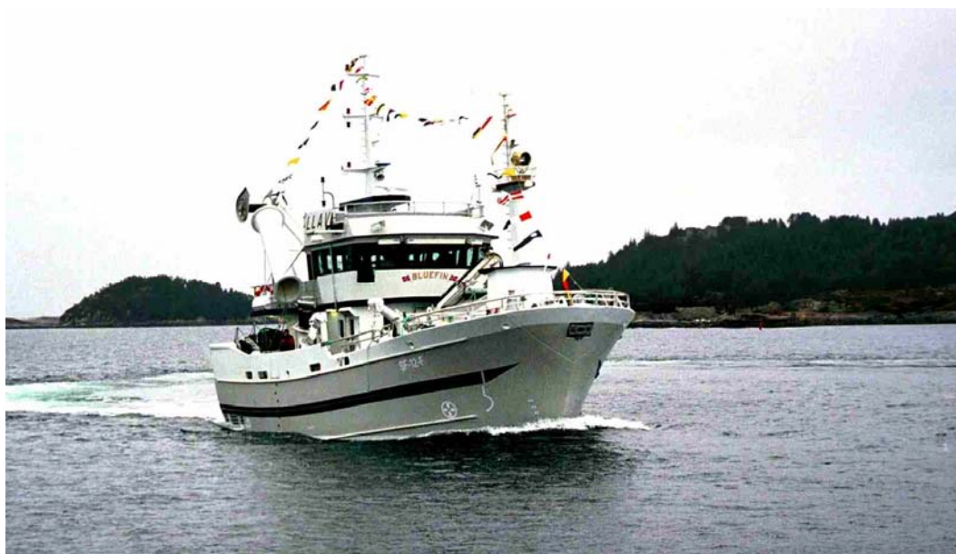
Figur 3.2: Bluefin, 70 fots fiskefartøy i sandwich bygget hos Mundal Båt AS
