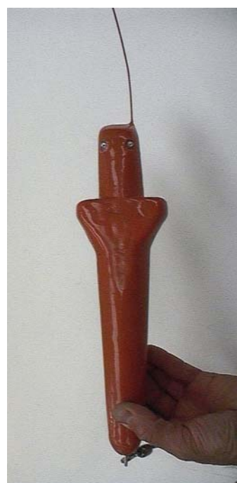
Bilde 5 Eksempler på radiosendere. Enheten til venstre er en rimelig enkel radiosender som er vanntett og som gir 6 måneder driftstid før batteribytte. Enheten til høyre er inne kapslet i et flyteelement og sender også ut en digital ID.
