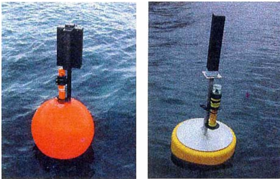
Bilde 2 Eksempler på bruk av radarreflektoren produsert av Nor Radar-Reflektor. Til venstre er fire element satt sammen rundt stangen til markeringsflagget, og til høyre er et element satt fast på dedikert bøye.
