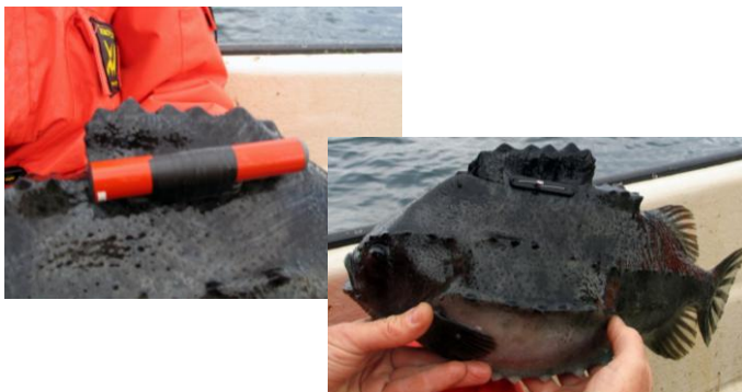
Figur 3. Akustisk merke festet med tynn ståltråd ved ryggfinne med plastplate som støtte.
