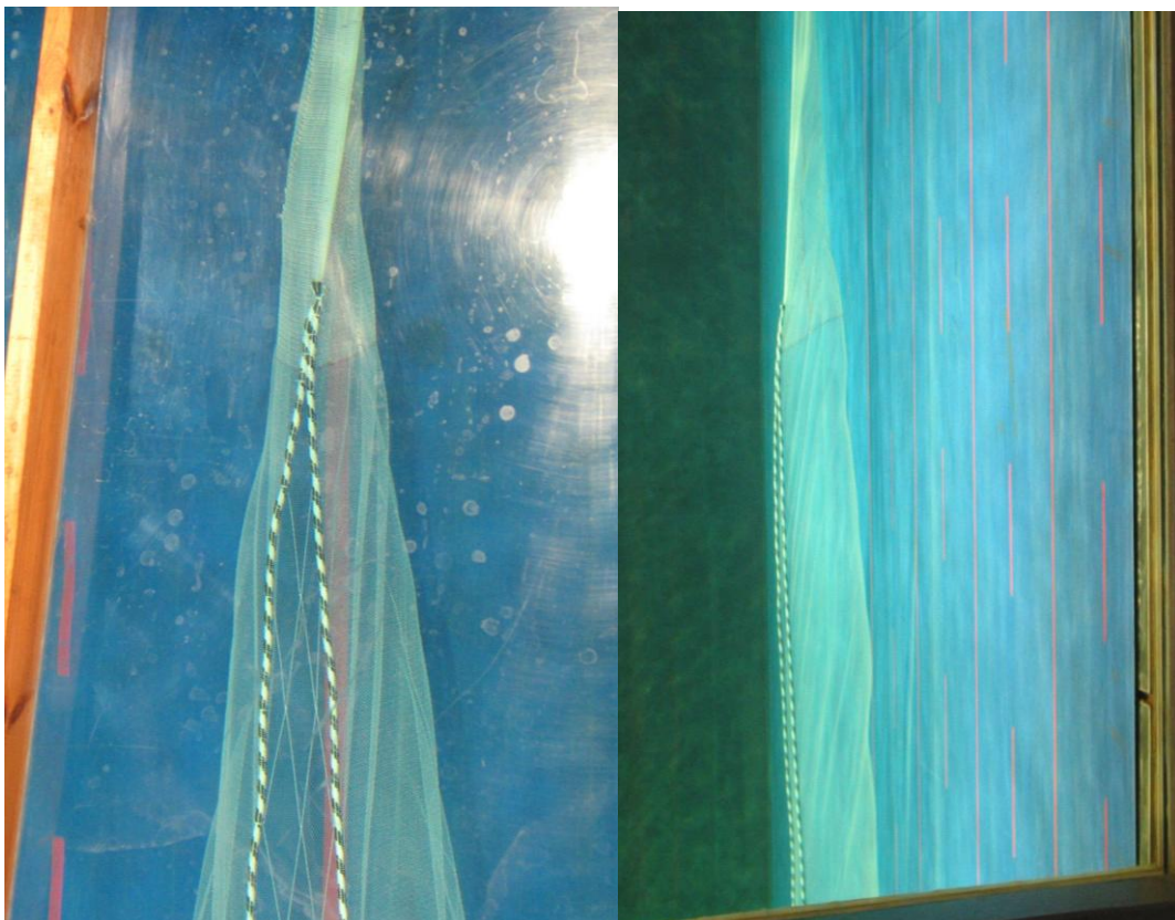
Figur 5. Bilder fra modellforsøk med den første varianten av trålen der belgen hadde to paneler.
