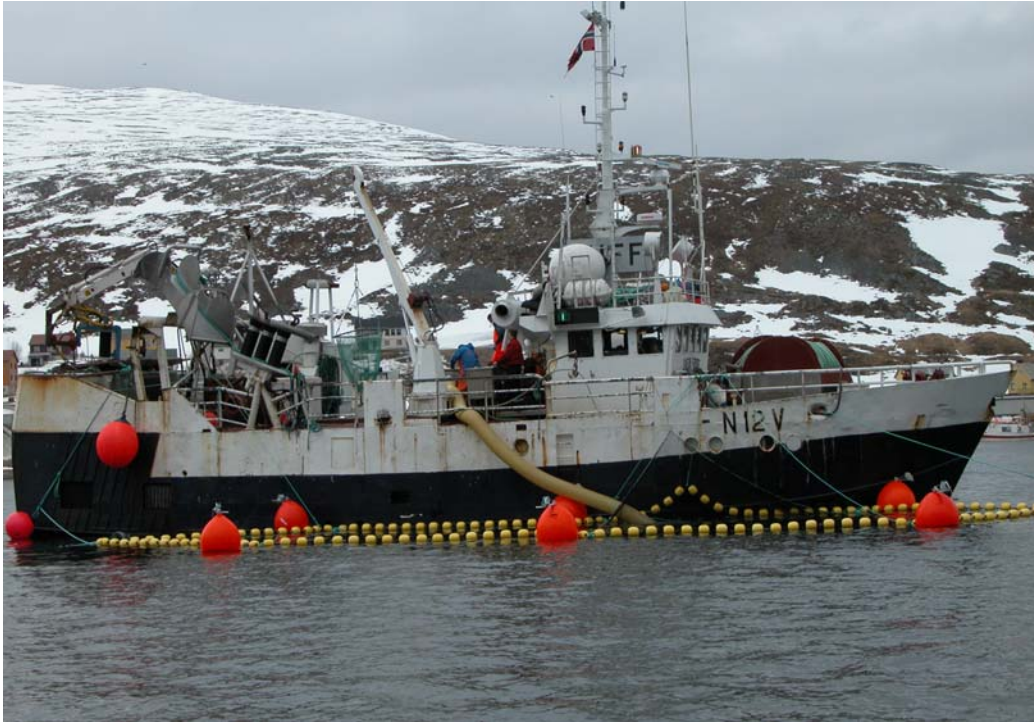
Bilde 6. Levering av fangst i feltmerd fra M/S "Svein Frode". Fleksislange stikkes gjennom "not-lokket" i merden og fisk slippes ned i merden.
