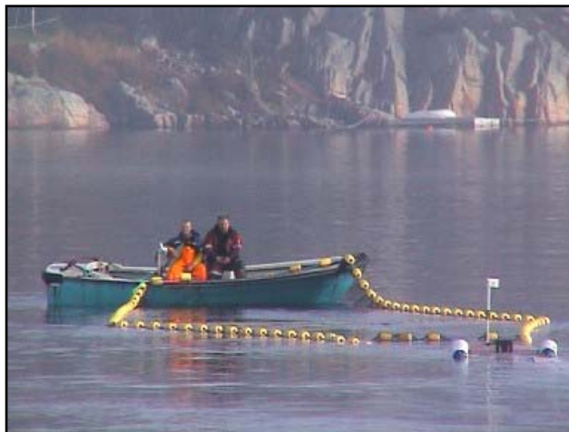
Bilde 17 Merden tørkes opp i lett båten og makrellen svømmer inn i slepeposen. Observasjonsrigg med undervannskamera og trådløs overføring av data sees i nedre billedkant.
