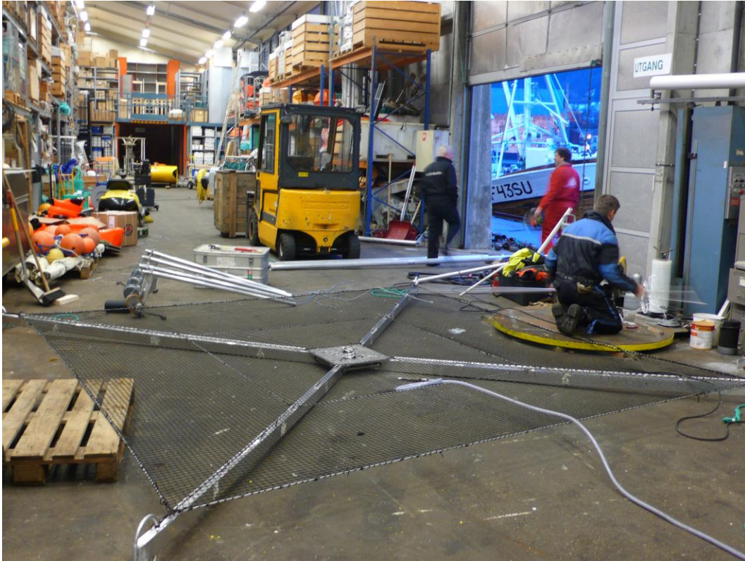
Figur 3. Flatbotn utspent med to rader med silkevire.
