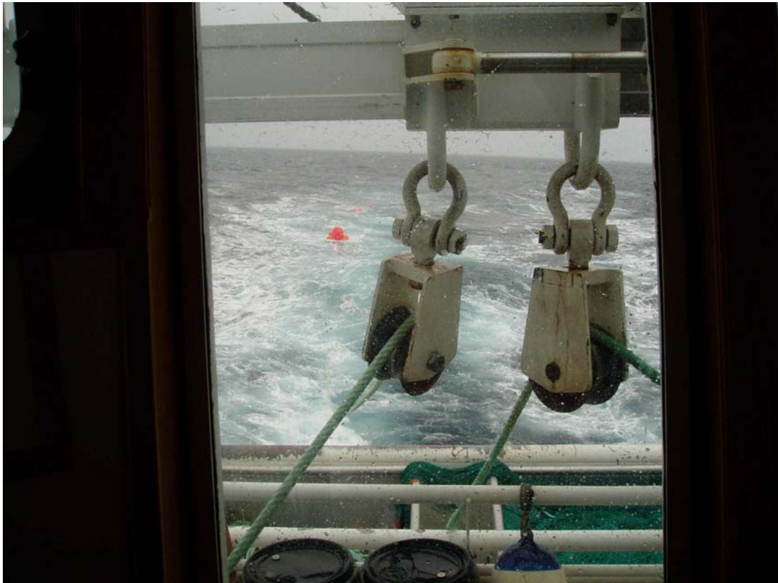
Bilde 11 Snurrevaden settes på nytt, her går markeringsbøyene og SB tauarm ut
