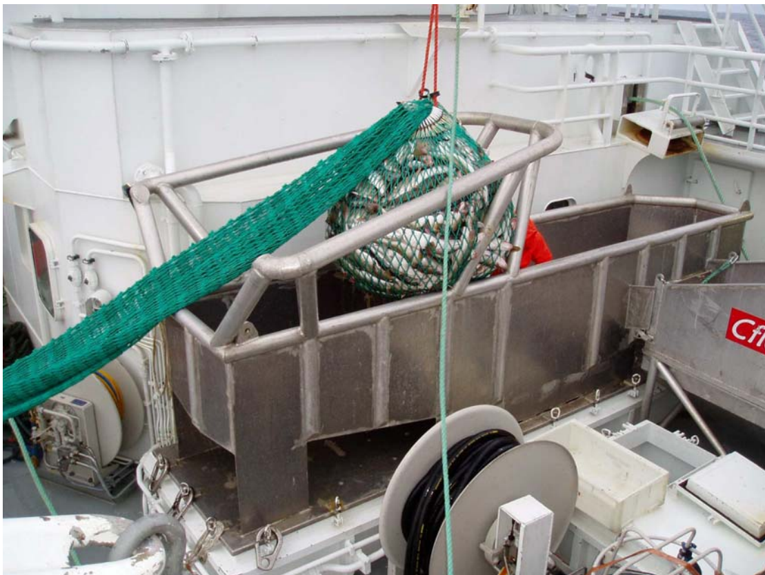
Bilde 14 Fiskesekken ledes inn mellom bøyer før tømning i mottaksbingen
