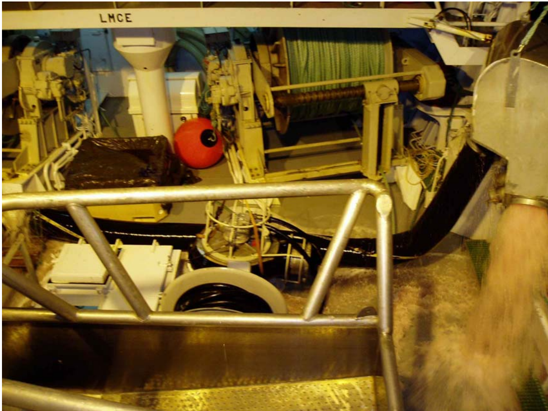
Bilde 25 Fleksibel pumpe­slange brukes over åpent shelterdekk fra BB til SB
