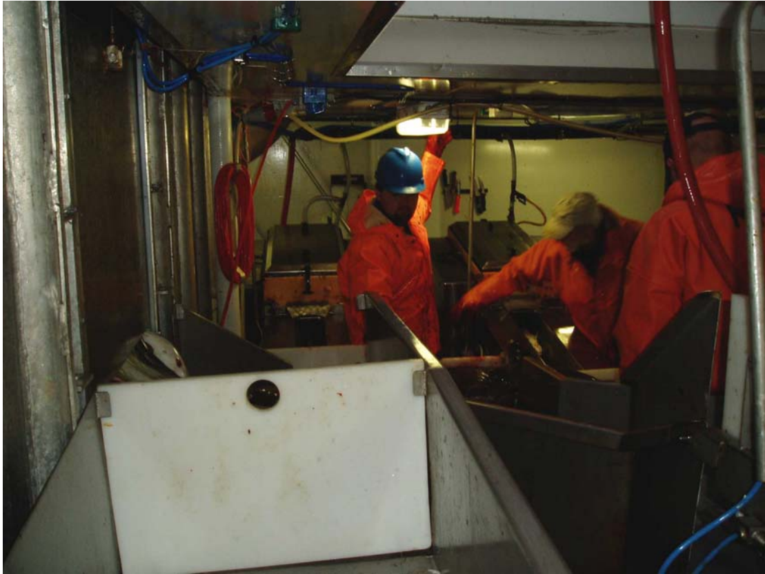
Bilde 15 Levende, ubløgget fisk slippes gjennom luftstyrt luke fra buffertank
