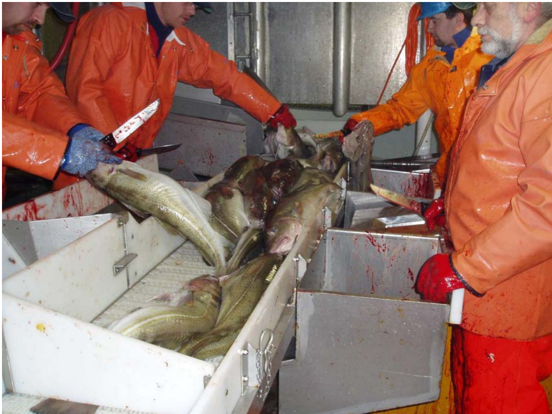
Bilde 16 Fisken direktesløyes manuelt etter uttak fra (ikke vannfylt) buffertank
