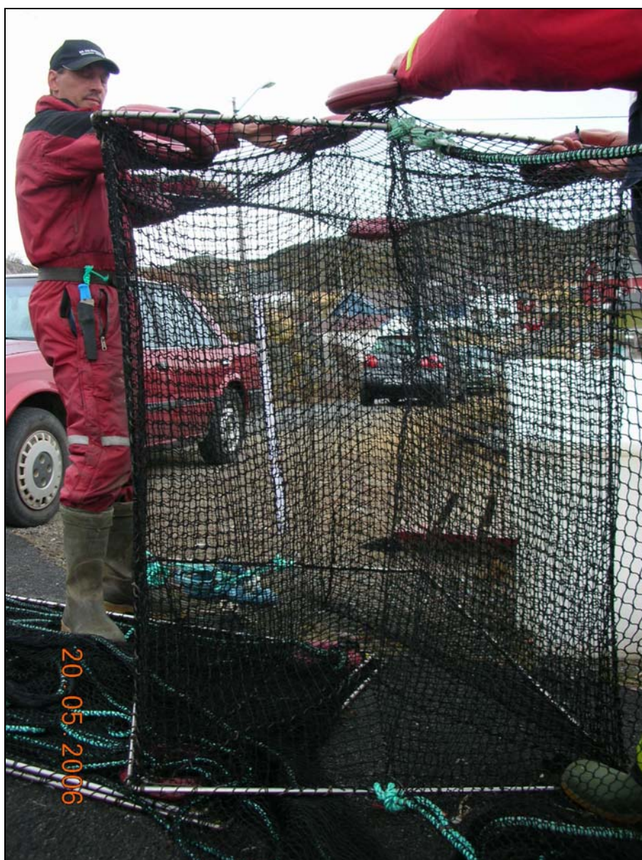
Bilde 1. Rusetype A – 1,2 m høyde på ledegarn og ruse, 20 m lengde ledegarn. Vi ser ledegarnet er knytt fast til rusen oppe og nede i front. Nede kan vi skimte den V-formede inner- og ytterkalv.
