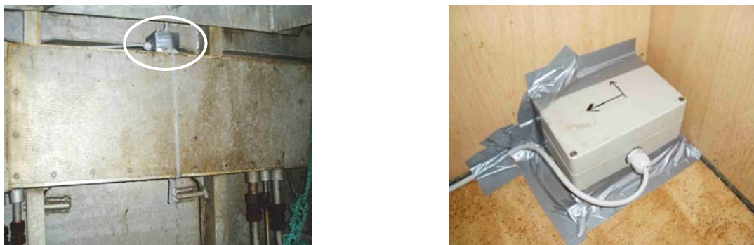
Fig. 3 Akselerometer under rull (til venstre) og i messe (til høyre)
