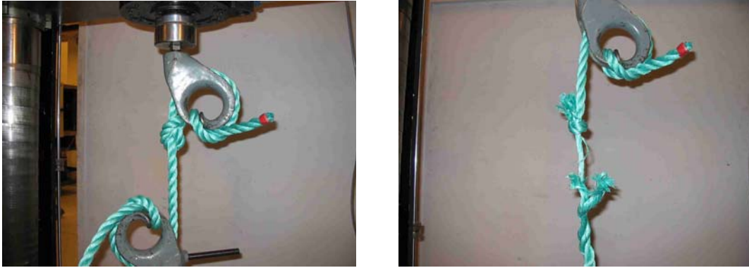
Fig. 5 Test av 18 mm flytetau med knute
