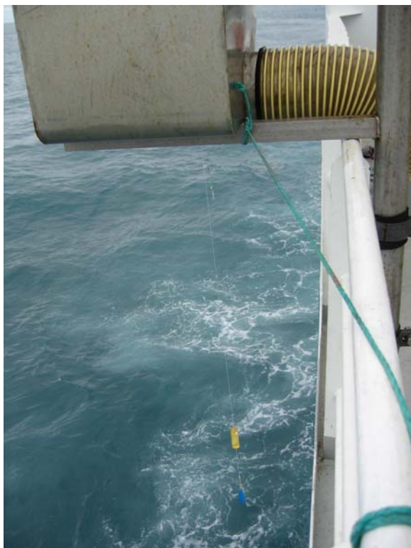
Figur 3. Bilde av CTD-beholder (gulhvitt) rett over loddet (blått, 500 g) på dorgemaskin.
