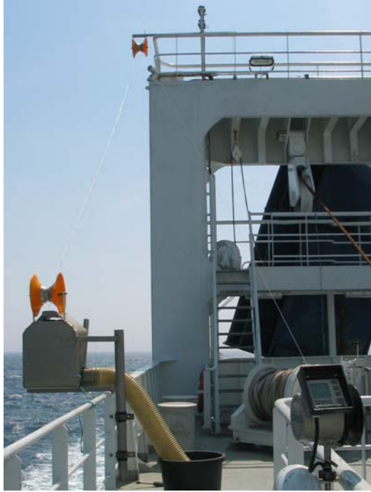
Figur 1. Dorgemaskin med kontrollpanel og fiskebøtte.
