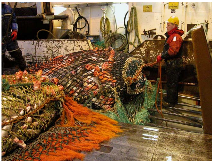
Bilde 1 De to trålposer klar på dekket til å bli tømt, T90 posen bakerst. Bemerk Alaskaknuten, slitnettet, og tovstykkene
