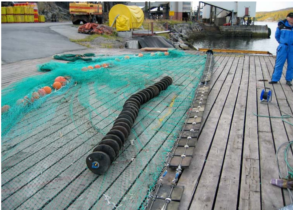
Figur 8. 1:2 skala modell av torsketrålen med fullstendig plategear montert. Rockhopper seksjonen er en midtseksjon som også ble testet sammen med plater som sidegear
