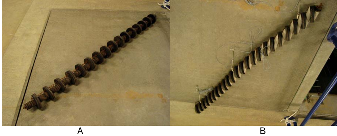
Figur 1. Sidegear av standard rockhopper (A) skiver, og av "tvangsstyrte" skiver (B).
