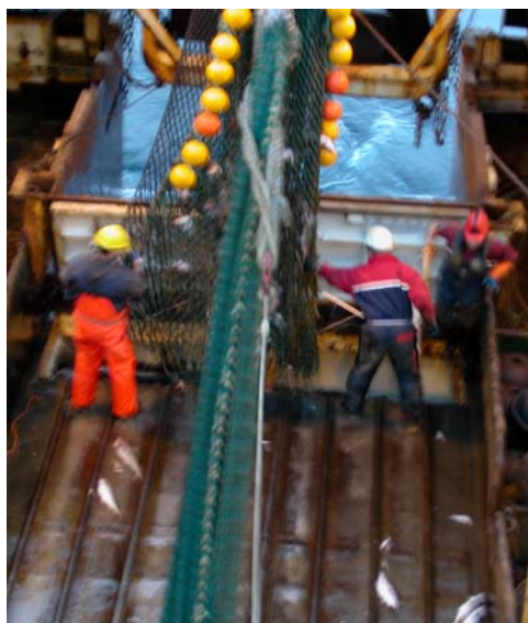
Bilde 5. Tråsekkken blir heist opp etter at den er tømt for fisk i kamrene før bløgging
