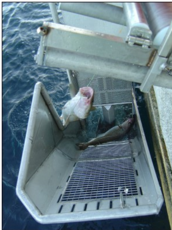
Med den automatiske linehaleren ved rekka fanges fisken opp i et oppsamlingskar, før den går bakover og heises om bord i båten Foto: Kjell Midling
