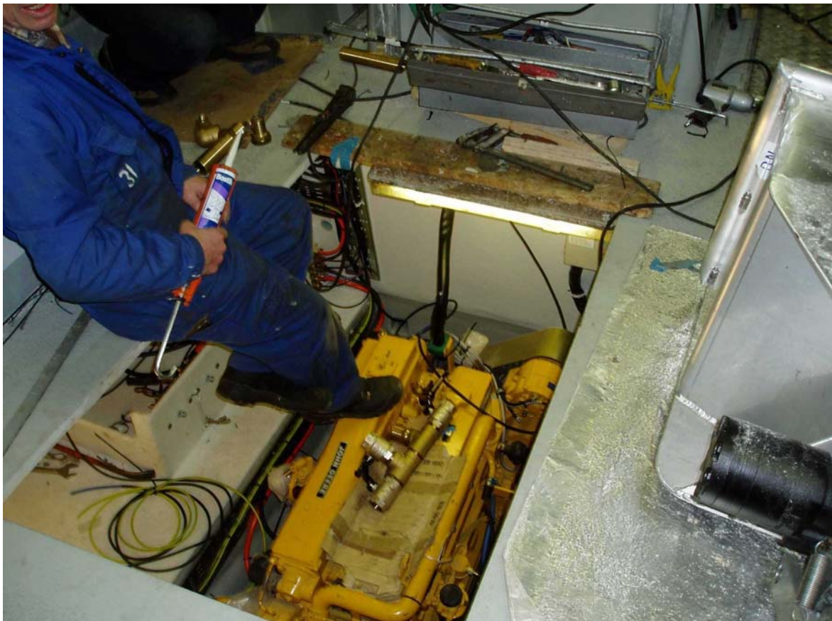
Bilde 11 Malo 35 fot - montering av diverse rør og pumpesystem fra maskinrom til lasterom
