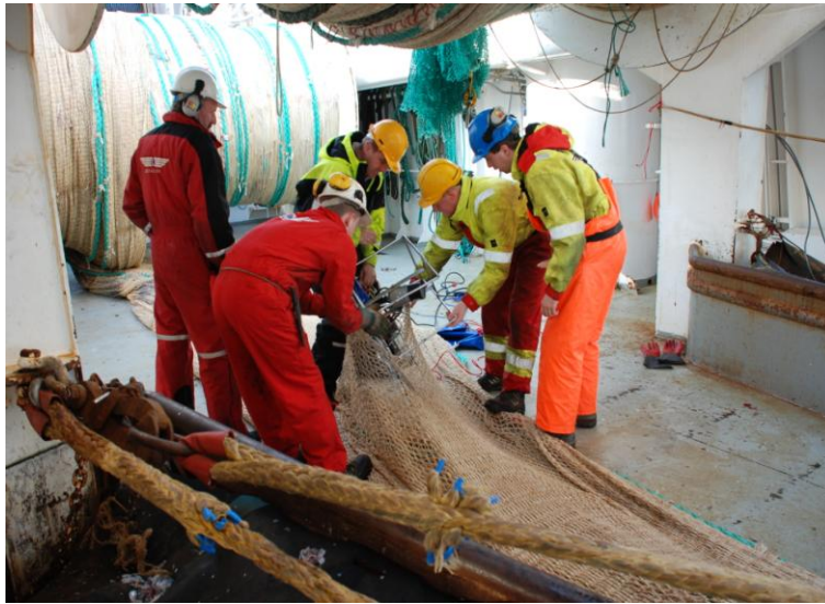
Bilde 4. Montering av kamera-rigg ca ti meter foran overgangen mellom trålpose og forlengelse. M/S "Selvåg Senior"
