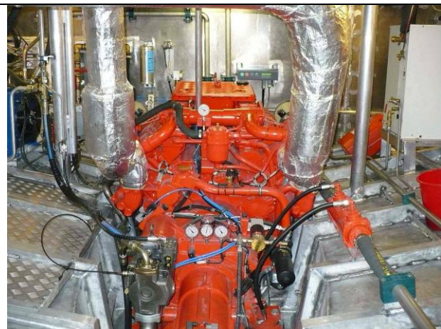
Hovedmotoren på 750 Hk er plassert i kjølkasse
