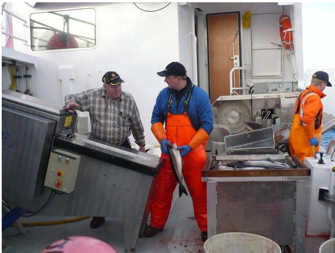
Bilde 16 Demonstrasjon av arbeidsstilling/operasjon ved bruk av sløyemaskin
