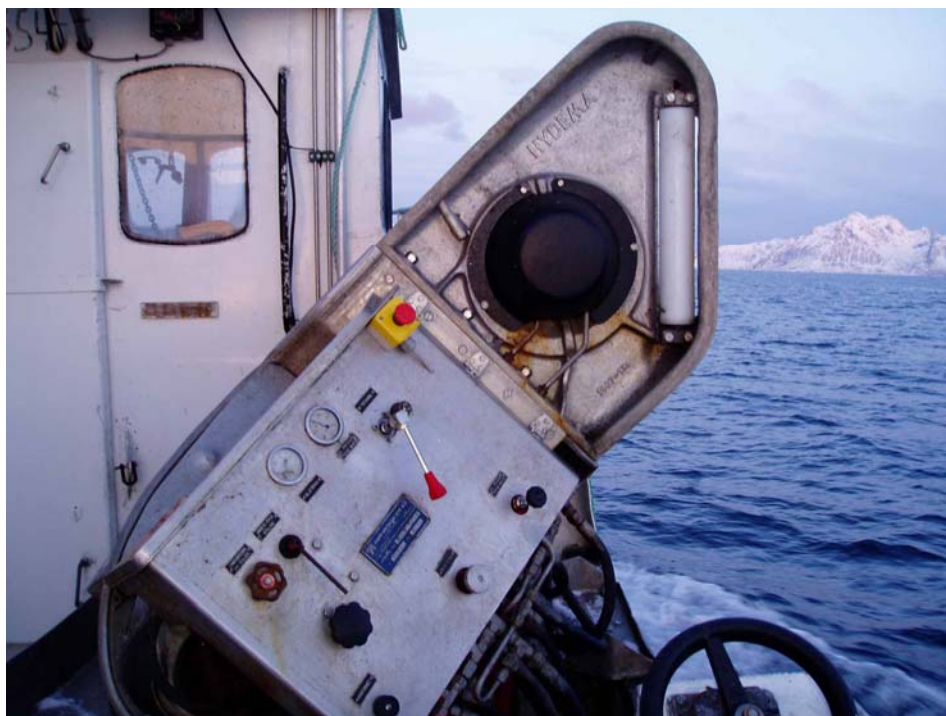
Bilde 19: Garnhaler om bord på en 35 fots garnsjark, påmontert en nødstoppbryter
