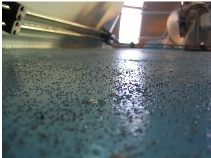
Bilde 10 Sklisikring med sandblandet maling på MS "Bjørnson", her under bygging på Mjosundet Båtbyggeri.
