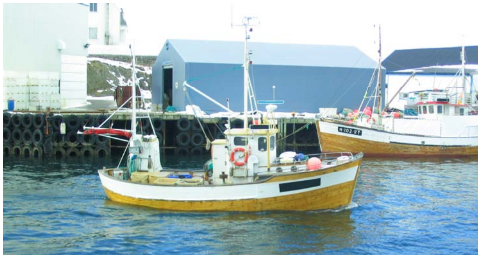
Bilde 13 Sjark under lofotfiske uten påmontert redningsleider og med lav rekkehøyde.
