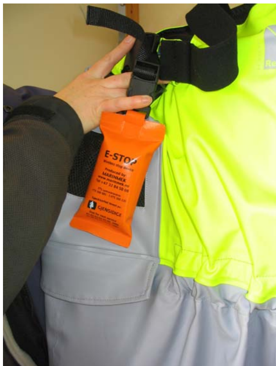
Bilde 4 E-STOP senderen utviklet av Marinmek her påmontert på ny type oljehyret, Regatta Fisherman, med flyteelementer
