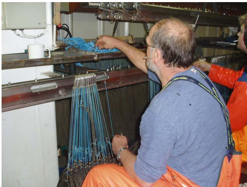
Bilde 2: Bøting av line og retting av kroker på autoline
