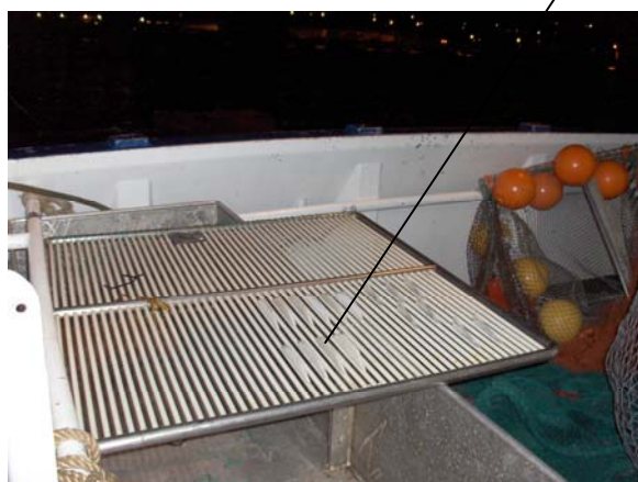
Figur 2. Arrangement av rist med avrettere i seksjon av kvadratiske masker foran en todelt pose benyttet ombord i M/S "Fangst"
