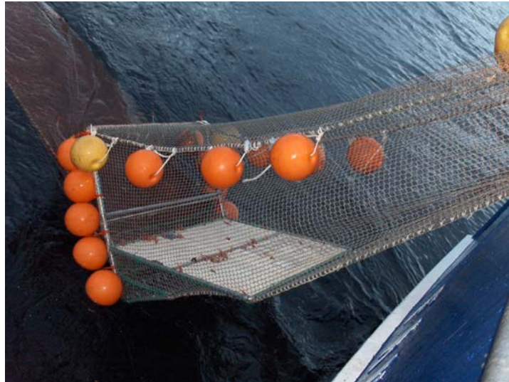
Figur 7. Rist med fastkilt reke under hiving av rist ombord i M/S "Fangst"
