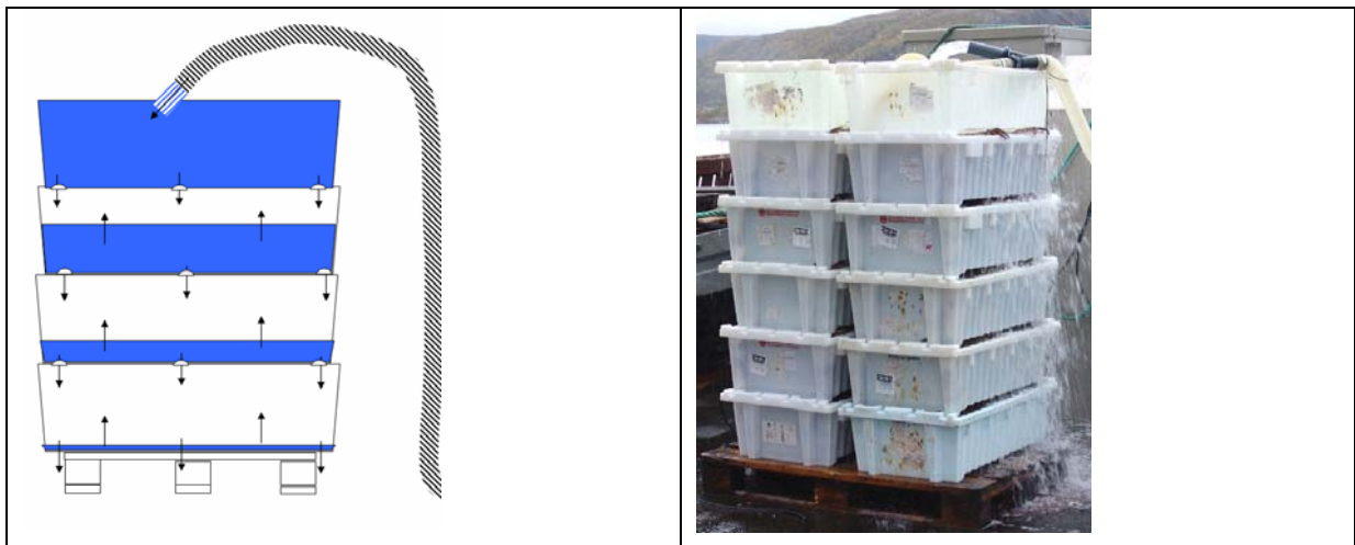
Figur 1. Stablekasser fra SE packing System AS. Til venstre vises en kassestabel med vanntilførsel. Til høyre SE kassen der hullene vises. Fra Dyb og Woll 2005.
