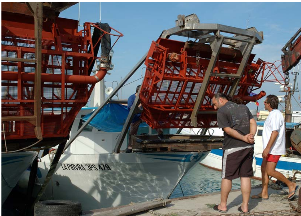
Fig. 12 "Turboblåsere" som de bruker under skjellskraping på åpent hav. Fra havna i Cattolica.
