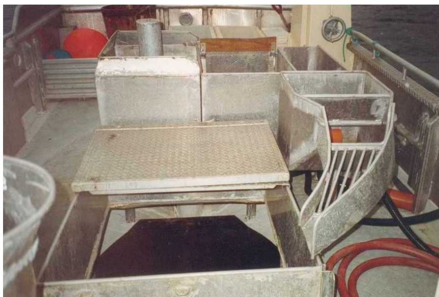
Bilde 5-6: System for fangstbehandling ombord på 34 fots sjark fra Skrasvåg
