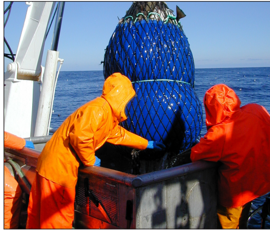
Bilde 23: Løftesekk med innmontert pressenningsylinder. Magebånd montert midt på løfteposen for å begrense volum og vekt av fisk i pose.
