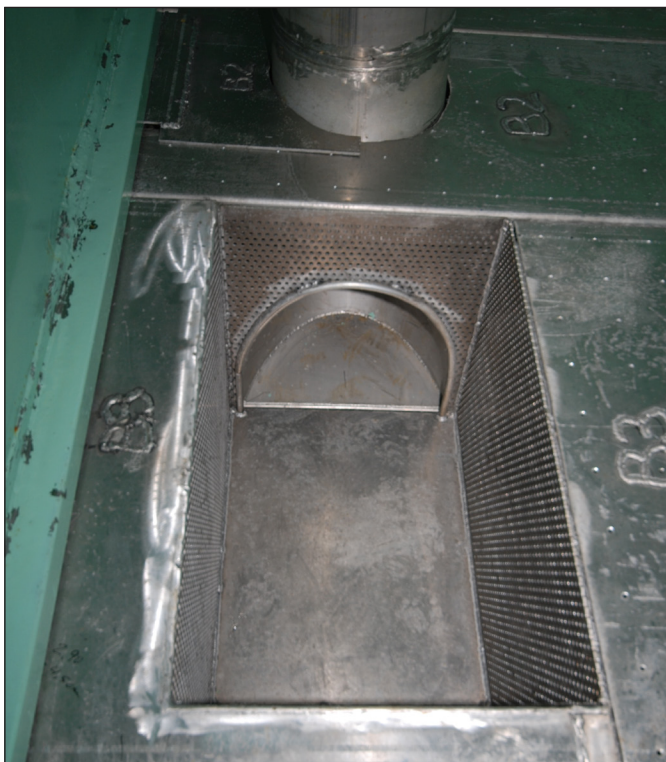
Bilde 41: Pumpebrønn med vanntilførsel skal utstyres med hengslet luke. M/S «TRINTO».
