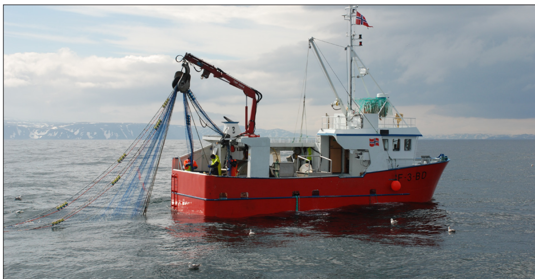
Bilde 14: Ombordtaking av snurrevad M/S «Rubin». Forsøk med parsnurrevad, M/S «Rubin» og M/S «Vesterbøen» april/mai 2010 og 2011.
