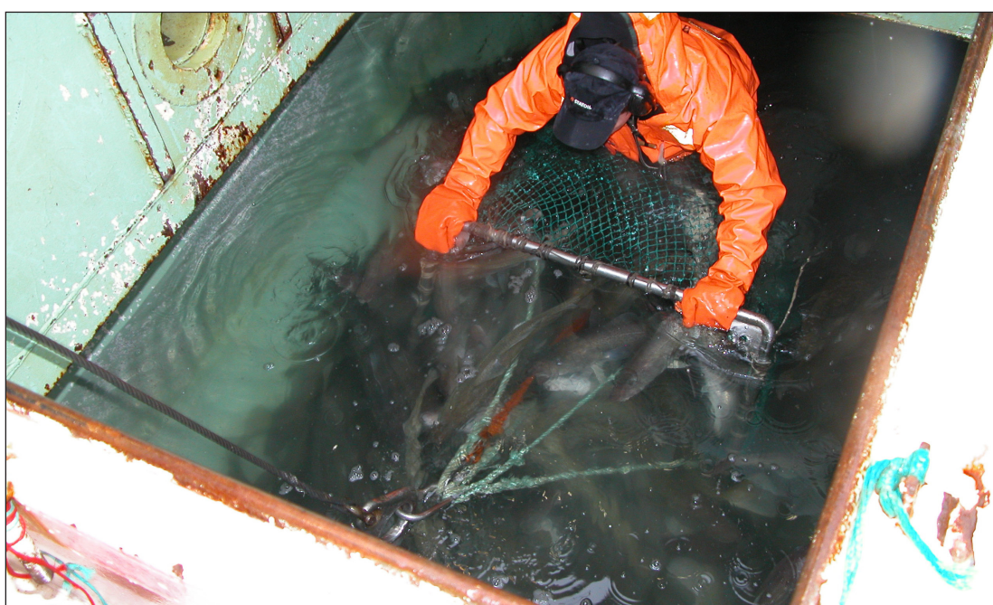
Bilde 43: Fisk håves opp av rom. Håven trekkes manuelt fram i rommet og tilbake ved hjelp av mantelwiren. Håven styres hele tiden av en fra mannskapet. Hver håv kan ta 200–300 kilo.
