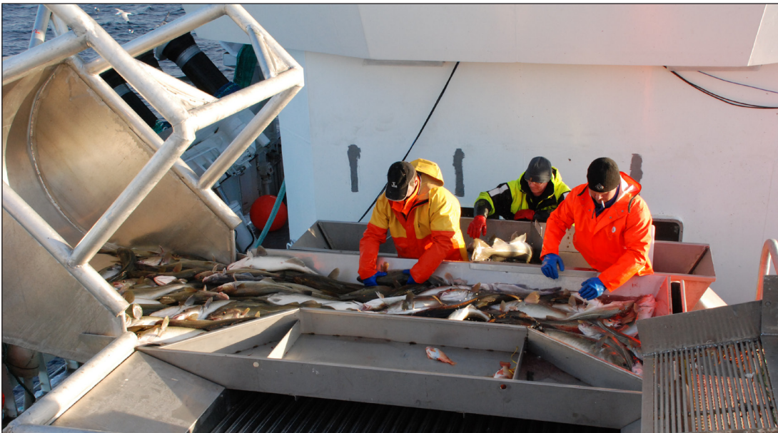
Bilde 31: Fisk tømmes i vannfylt vugge, og helles inn på sorteringsbord for sortering og telling.
