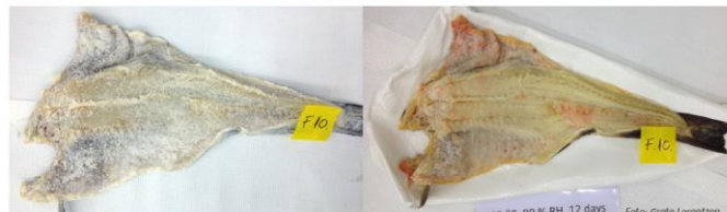
Samme klippfisk før og etter lagring i 12 dager ved 35 °C og 80 % relativ luftfuktighet.
